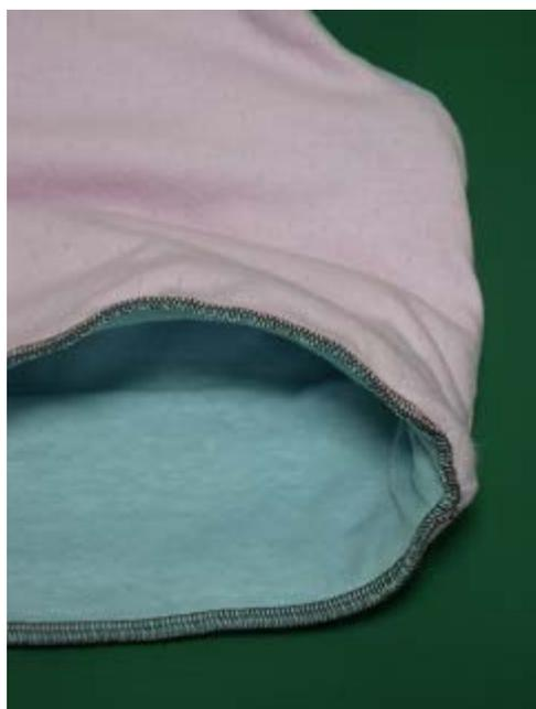
5 mm切り落としながら 5 mm巾のロックで縫い合わせます。(※覗き込む感じで縫い進めます。)
