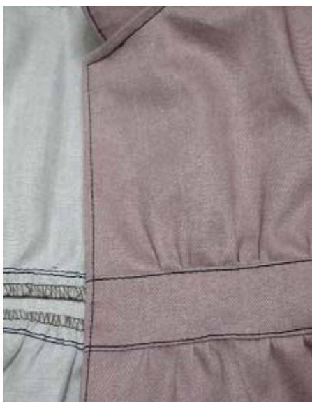
「衿付け止まり～前端～裾～反対側前端～反対側衿付け止まり」の出来上がり線にアイロンをかけ、ステッチをかけます。
